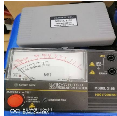
เครื่องวัดความต่อเนื่องของตัวนำและฉนวน สายไฟฟ้า
