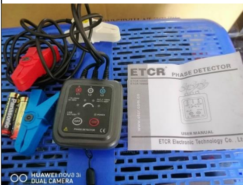
เครื่องมือวัด PHASE SEQUENCE (วัดลำดับเฟส ไฟ 3 เฟส)
