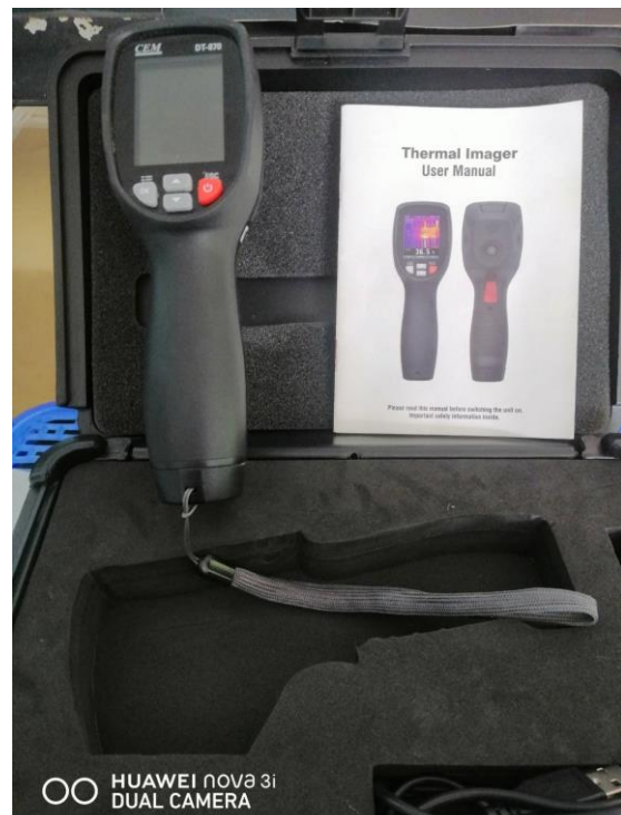
เครื่องวัดอุณหภูมิผิววัสดุแบบถ่ายภาพความร้อน(thermoscan)
